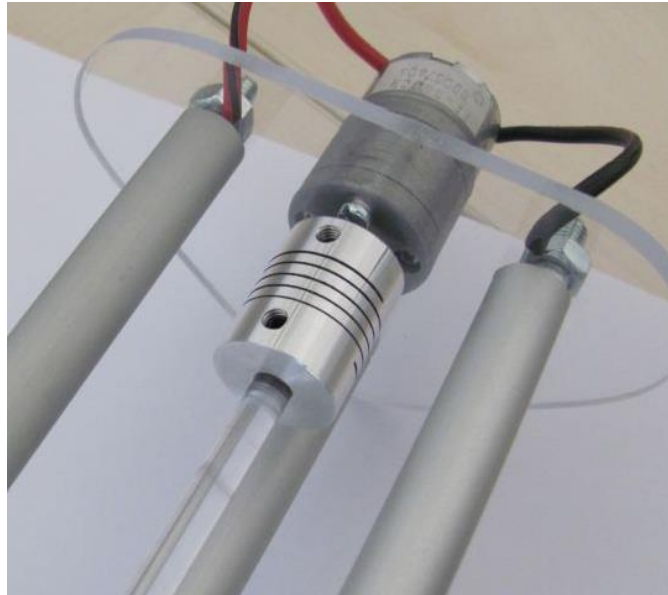
Učvršćivanje osovine za Alu glavu motora s nimbus vidicama u glavi
