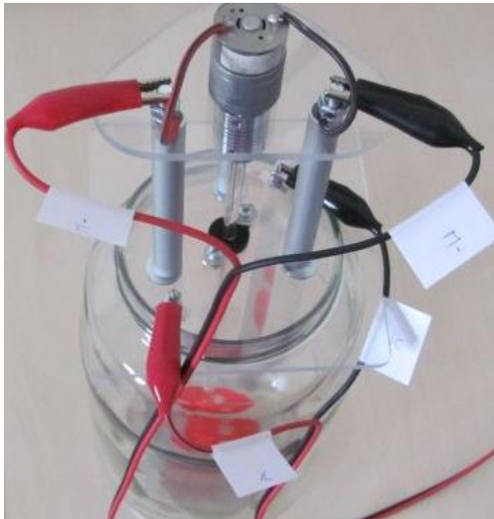
Ispravno spojena miješalica
